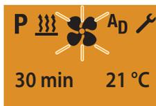
Режим отображения для воздухонагревательных приборов при продолжительном режиме ВЕНТИЛЯЦИЯ.
