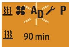
Режим отображения для воздушнонагревательных приборов при продолжительной работе в режиме обогрева (заводская настройка).
