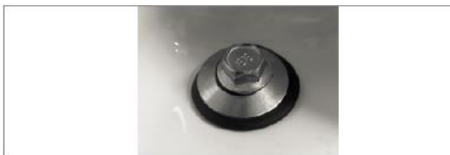
Рис. 30: Корректная установка обрезиненной шайбы
