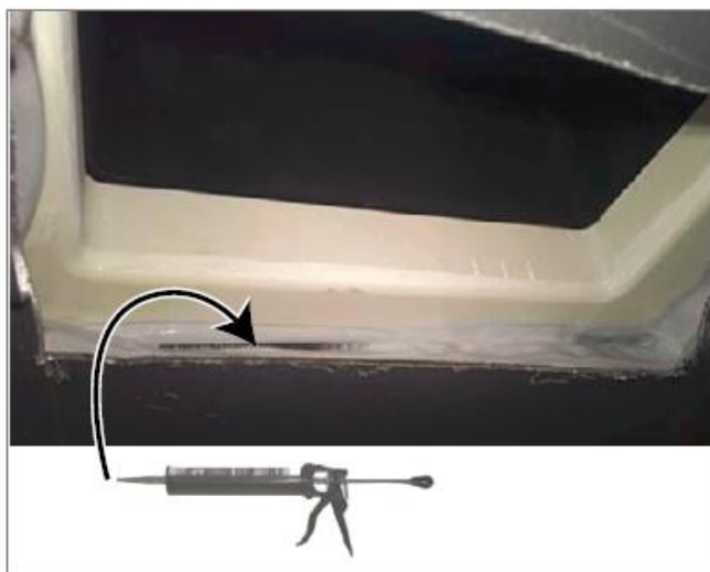
Рис. 15: Нанести герметик изнутри ТС
